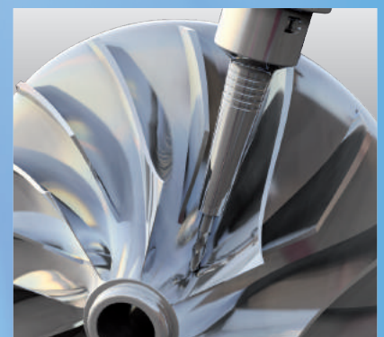
5-Achsbearbeitung mit Kugelfräser Finishing with ball endmill on 5-axis machine
