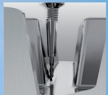
Schlichten mit Kugelfräser in engen Werkstückstellen Finishing with ball endmill in tight space
