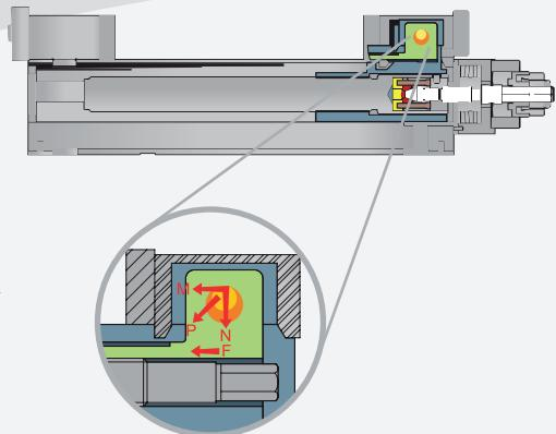
Durch das neue Anti-Lift-System werden die Werkstücke beim Spannen niedergedrückt und präzise gespannt
